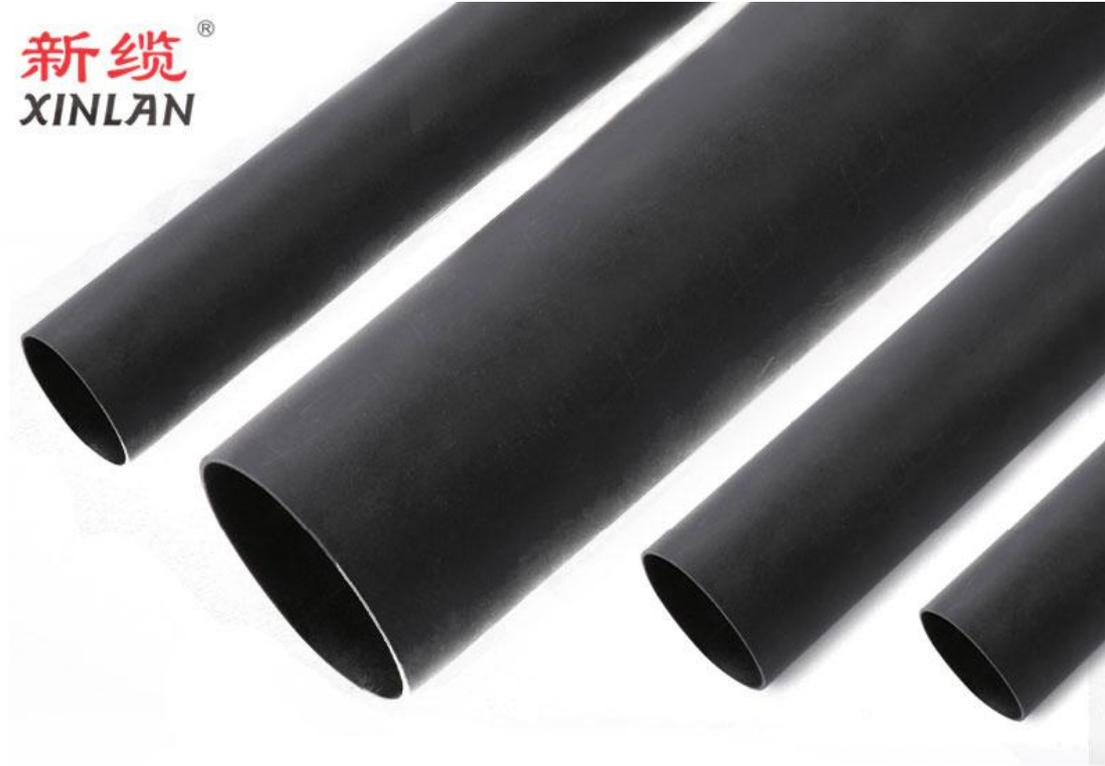
产品特性：热缩复合双壁管是由热缩绝缘材料和热缩半导体材料经过特殊工艺加工而成的、内层具有良好的绝缘特性，外层具有半导体性能，外层与内层间结合紧密，屏蔽可靠。
